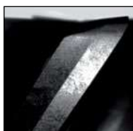
Krawędź skrawająca w powiększeniu x 20 (zdjęcie z maszyny Zoller) Cutting edge in magnification 20x (photo from Zoller machine)
