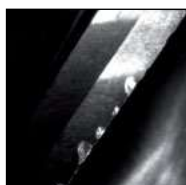
Krawędź skrawająca w powiększeniu x 20 (zdjęcie z maszyny Zoller) Cutting edge in magnification 20x (photo from Zoller machine)
