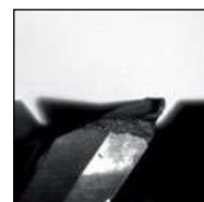
Krawędź skrawająca w powiększeniu x 20 (zdjęcie z maszyny Zoller) Cutting edge in magnification 20x (photo from Zoller machine)
